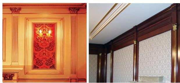
Пилястра – четырехгранный столб (полуколонна), одной гранью вделанный в стену, декоративный элемент для вертикального разделения стены и улучшения пропорций интерьера.
